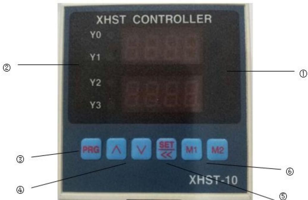
① 显示框（四位数字）：上面四位显示功能代码，下面四位显示步进时间段、步进输出段。
